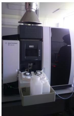
Espectrofotómetro (ICP-OES) ICAP 6500
